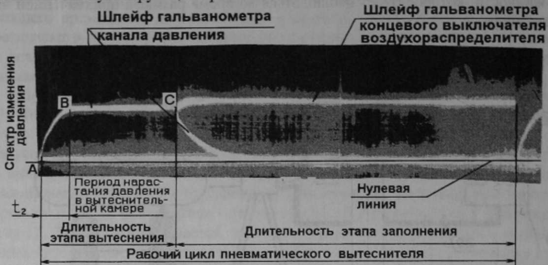
Рис. 2. Рабочий цикл пневматического вытеснителя
