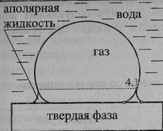
Рис. 1 – Схема закрепления пузырька на минерале в присутствии аполярного реагента
