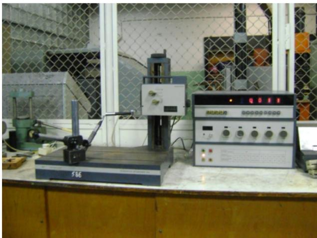
Рис. 4. Общий вид профилограф-профилометра модели 252 (рис. 4) со специальным приспособлением для измерения параметров шероховатости поверхностей фрез
