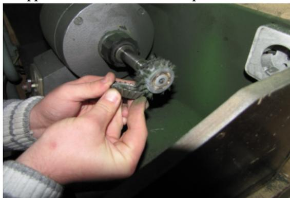
Рис. 7. Полировальный станок для выполнения операций полировки и глянцеваания поверхностей фрезы
