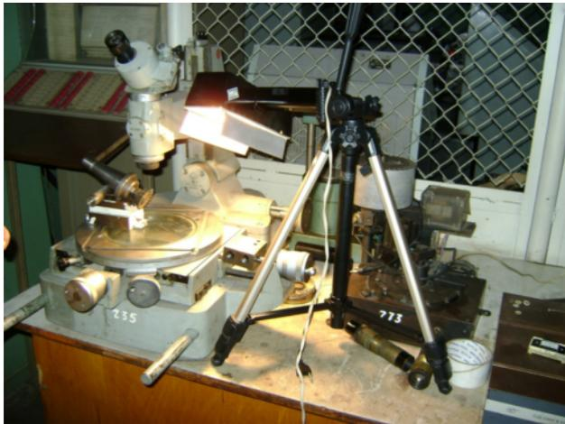
Рис. 12. Измерение величины износа задней поверхности зуба фрезы с применением инструментального микроскопа БМИ-1 с приспособлением, установленным на столе микроскопа
