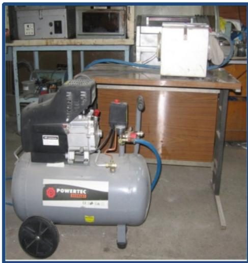
Рис. 6. Общий вид установки для пневмоструйной обработки фрез
