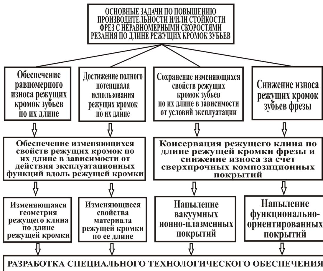
Рис. 2. Основные задачи по повышению производительности и/или стойкости фрез с неравномерными скоростями резания по длине режущих кромок зубьев
