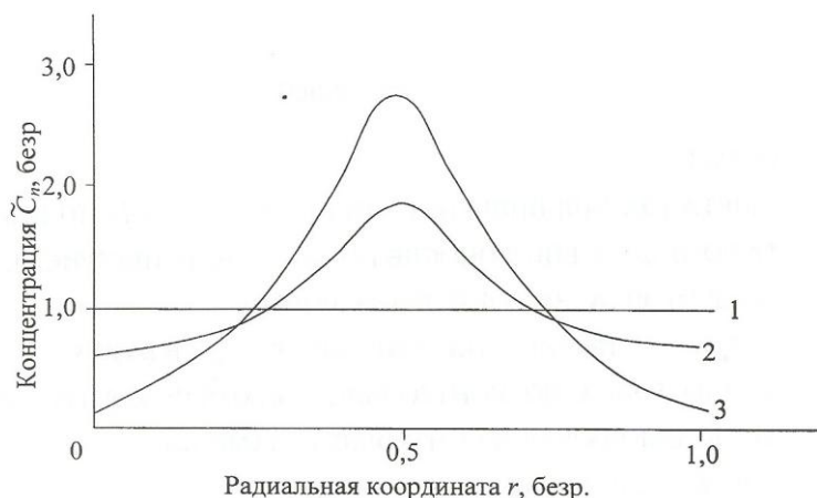
Рисунок 2 – Распределение безразмерной концентрации \tilde{C}_n атомов водорода на межфазной поверхности «металл-вакуум»: 1- i=0 ; 2- i=0,5 ; 3- i=1,0 ; E = 2,0 \cdot 10^{+5} В/м
