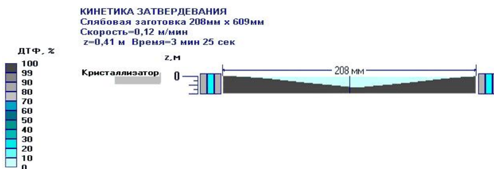
Рисунок – Кинетика затвердевания плоского слитка
