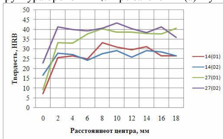
Рисунок 2 – Изменение твердости бронзы БрОЦС по сечению заготовки
