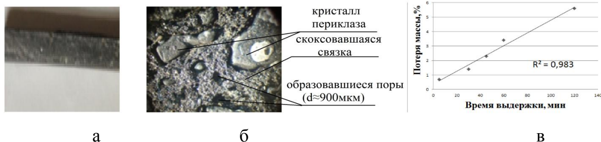
Рисунок 1 – Результаты исследований периклазоуглеродистого огнеупора
