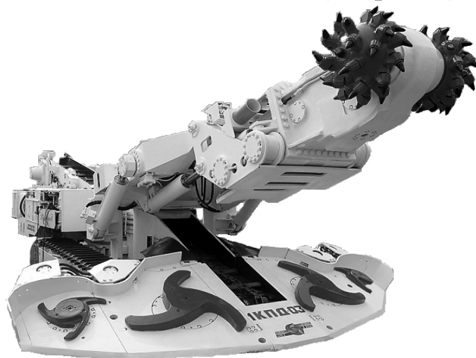
Рисунок 1 – Проходческий комбайн КПД
