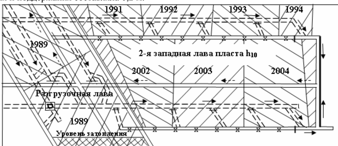
Рис. 1. Схема горных выработок 2-ой западной лавы пласта h_{10} шахты им. М.И.Калинина
