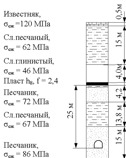
Рис.1. Стратиграфия пласта h_8 и схема расположения полевого вентиляционного ходка в породах почвы пласта
