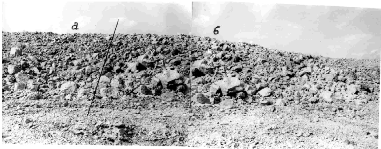
Рис.6. Вид взорванной горной массы при взрывании доломитизированных известняков (Восточно-Доломитный карьер ДФДК) а) экспериментальный участок; б) контрольный участок
