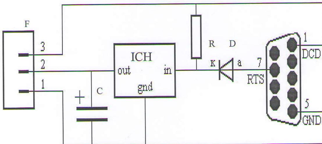
Рис. 1. Схема пристрою дистанційного керування комп'ютером
