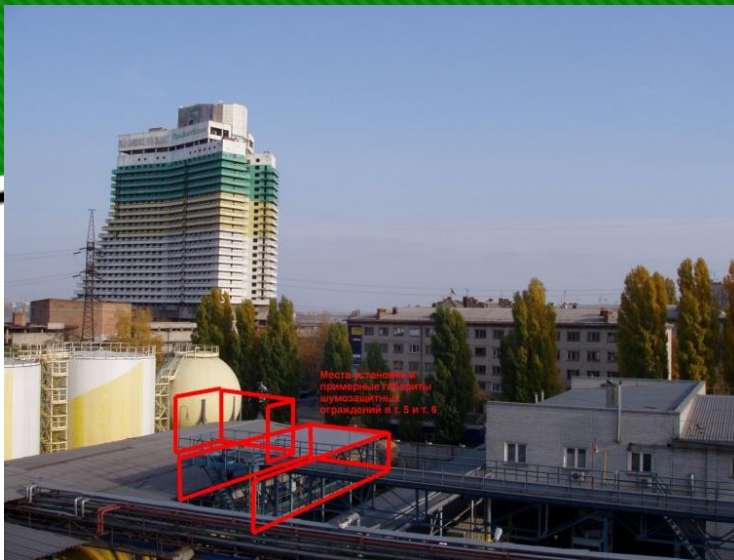
Принципове рішення розміщення зовнішньої додаткової огорожі
