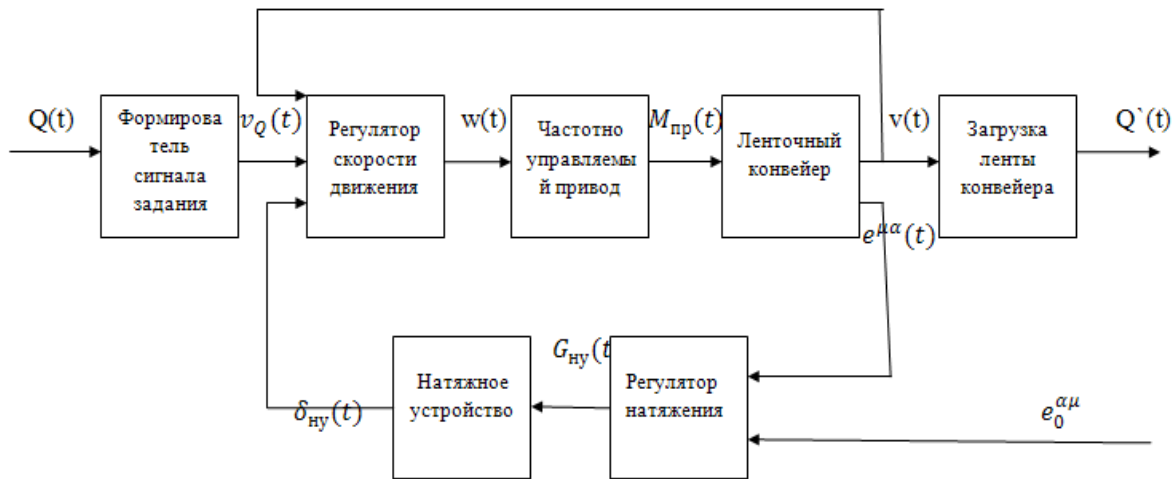
Рисунок 2 – Структурная схема стабилизации погонной нагрузки движения ленты конвейера со стабилизацией тяговой способности привода конвейера
