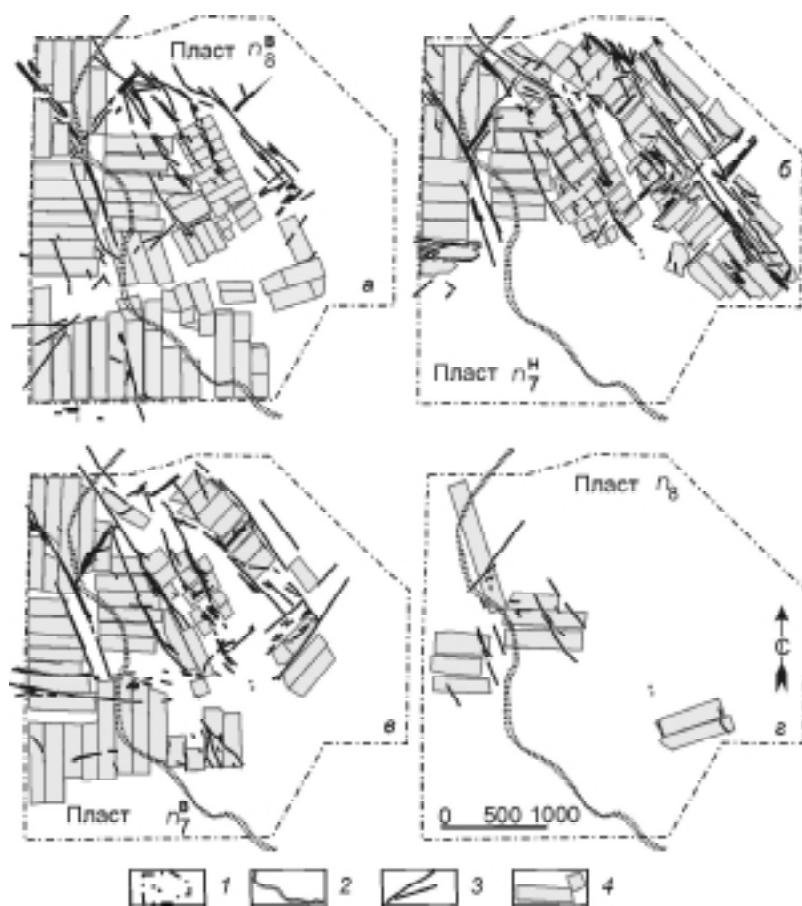
Рис. 2. Цифровые модели тектонической нарушенности угольных пластов в пределах горного отвода шахты «Великомостовская» №5: а – n_8^B ; б – n_7^H ; в – n_7^B ; з – n_8 ; 1 – границы шахтного поля и стволы шахты; 2 – речная сеть; 3 – разрывные нарушения; 4 – контуры горных работ по угольным пластам
