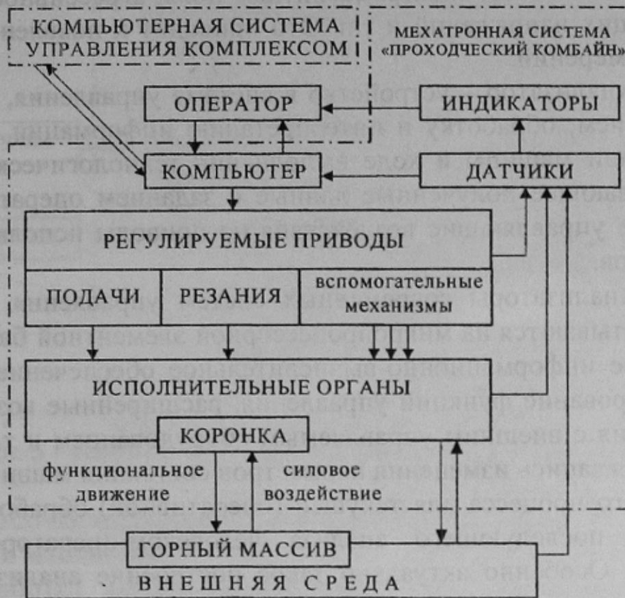
Рисунок 2 – Структура мехатронной системы «проходческий комбайн»
