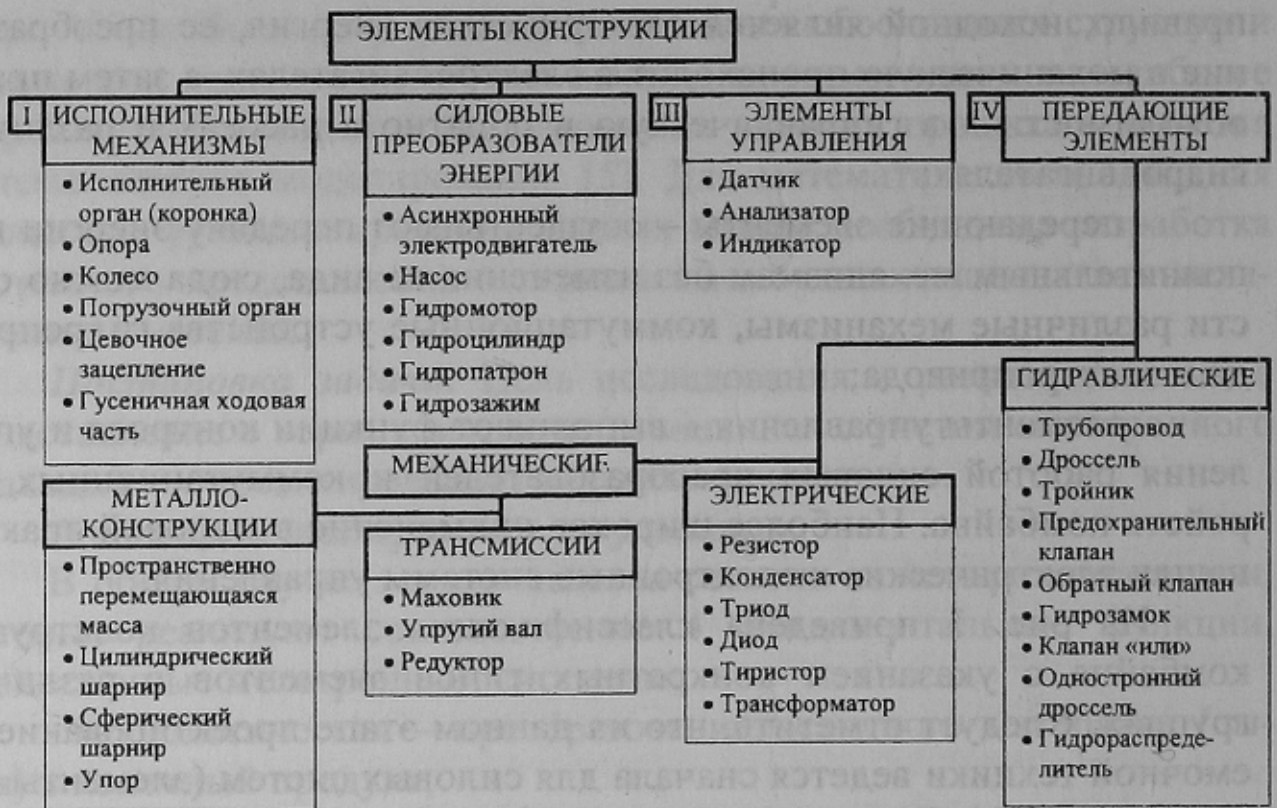
Рисунок 1 – Классификация элементов конструкции горной машины
