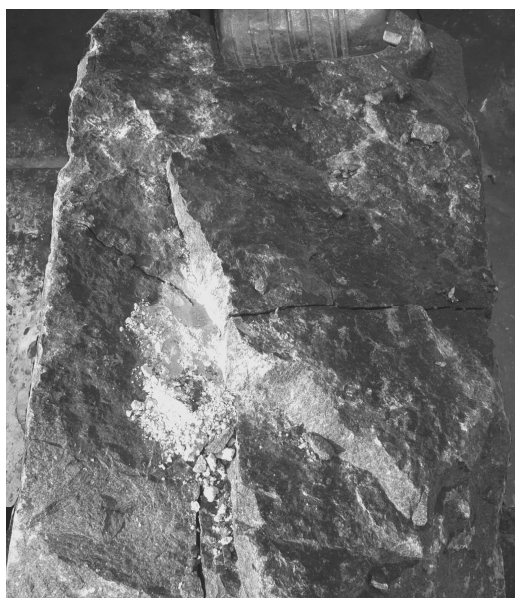
Рис. 3. Общий вид разрушенного негабарита после извлечения распорного устройства
