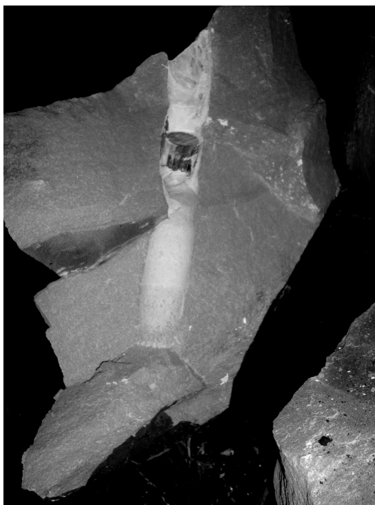
Рис. 4. Общий вид стенок шпура с НРС при формировании шпурового заряда с предварительным сжатием смеси деревянным клином после разрушения блока
