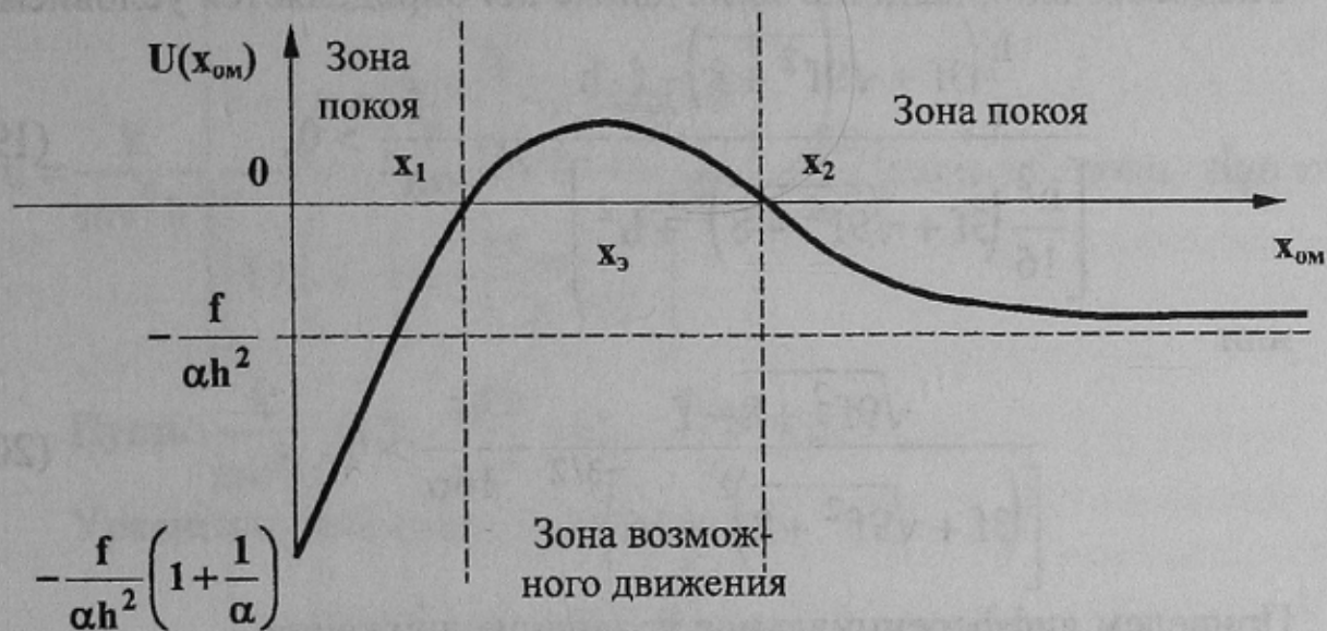
Рис. 3 – К анализу уравнения движения груза
