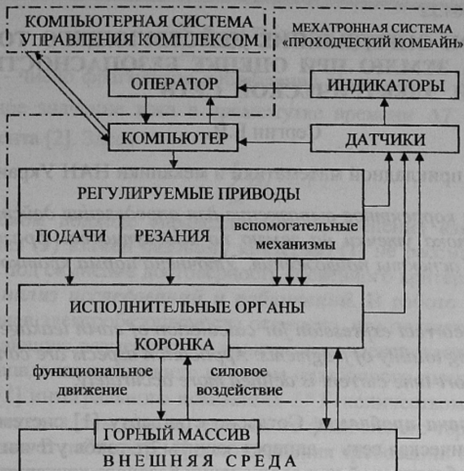
Рисунок 2 – Структура мехатронной системы «проходческий комбайн»
