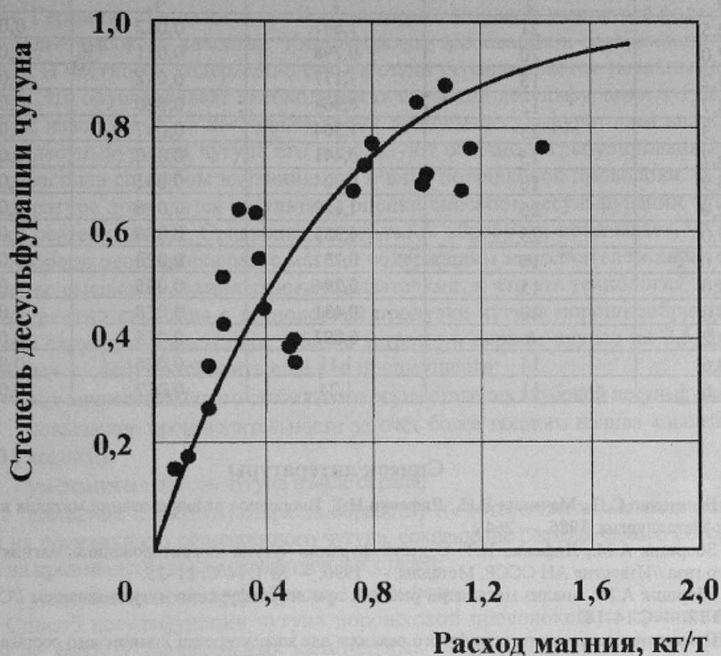
Рисунок 1 - Зависимость степени десульфурации чугуна при обработке магнием в циркуляционном газлифтном реакторе от удельного расхода реагента
