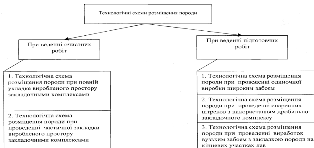
Рисунок 2 - Класифікація основних технологічних схем розміщення породи в шахті
