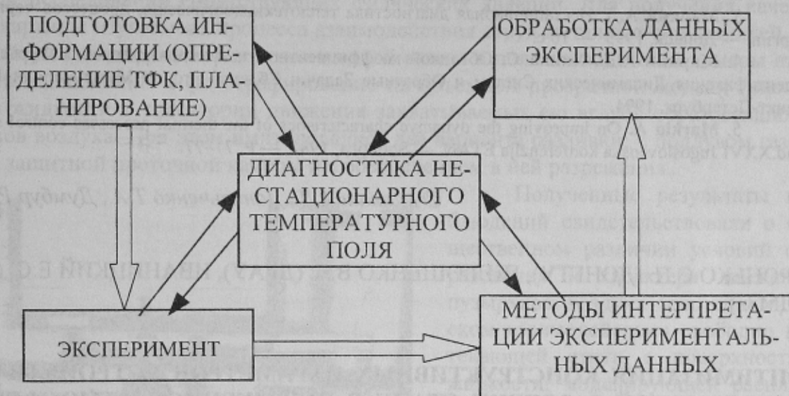
Рис. 3. Схема диагностики ТТП
