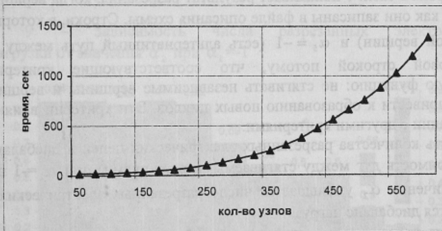
Рисунок 8 – Зависимость времени работы от количества узлов в графе процессоров
