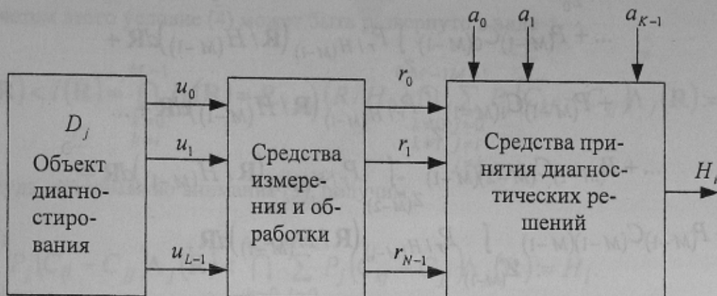
Рис.1 Обобщенная структура ИИС диагностирования промежуточных состояний объектов механического оборудования
