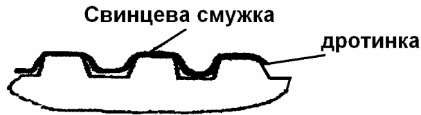
Рис. 1.1 Розташування свинцевої смужки на зубах колеса
