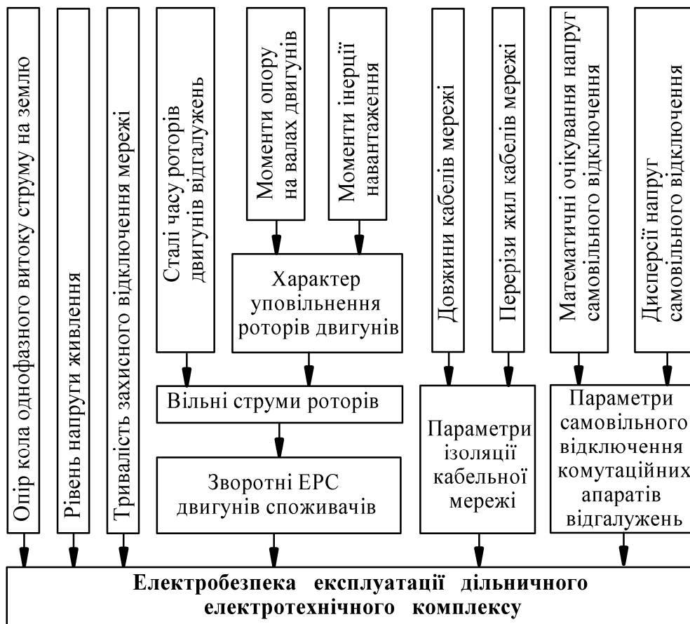
Рис. 3.20. Структурна схема для ілюстрації впливу на електробезпеку ЕТК ДШ параметрів елементів та режимів їх роботи
