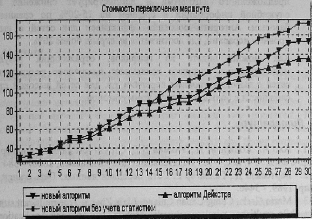
Рис. 3. Зависимость временной сложности ремаршрутизации (стоимость переключения маршрута) от размера Multicast группы при уровне дерева, равном 2.
