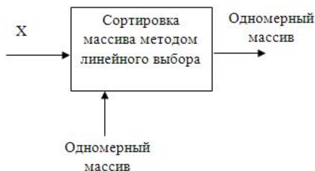
Рисунок 4. SADT-диаграмма сортировки элементов одномерного массива методом линейного выбора
