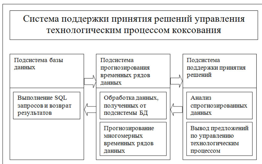
Рисунок 1. Структура комплекса программных средств разрабатываемой системы
