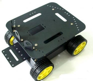
Рисунок 3. Конструкция платформы
