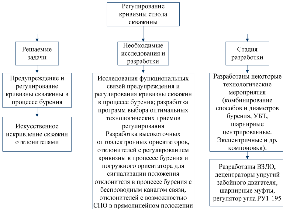
Рис. 5. Схема системы «направленное бурение» – Анализ ситуаций
