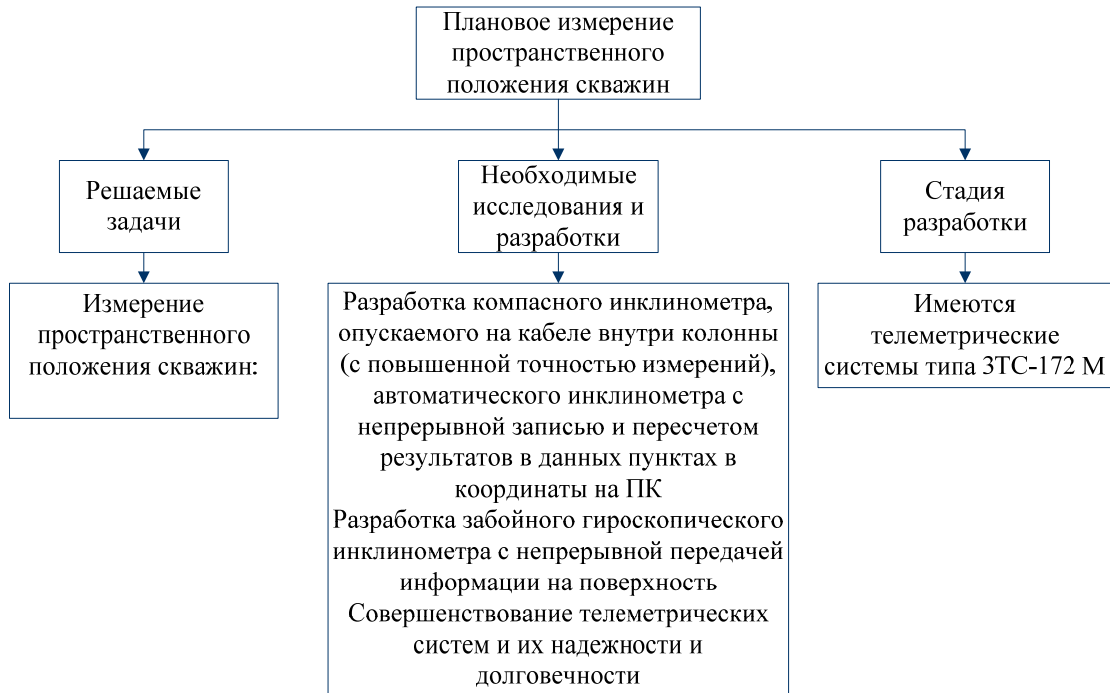
Рис. 7. Схема системы «направленное бурение» – Плановое измерение пространственного положения скважин
