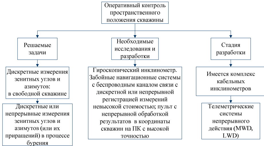
Рис. 4. Схема системы «направленное бурение» – Оперативный контроль пространственного положения скважины
