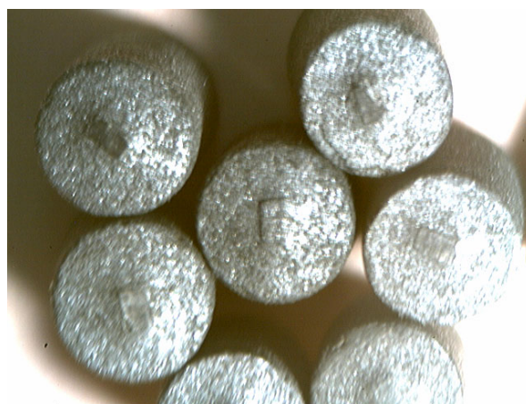
Рис.3. Общий вид цилиндрических породоразрушающих элементов из гибридного композиционного материала.
