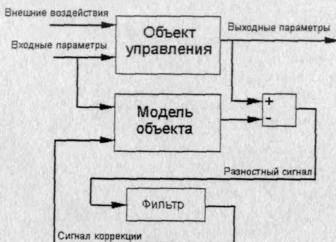
Рис. 1 – Поток информации с использованием модели объекта
