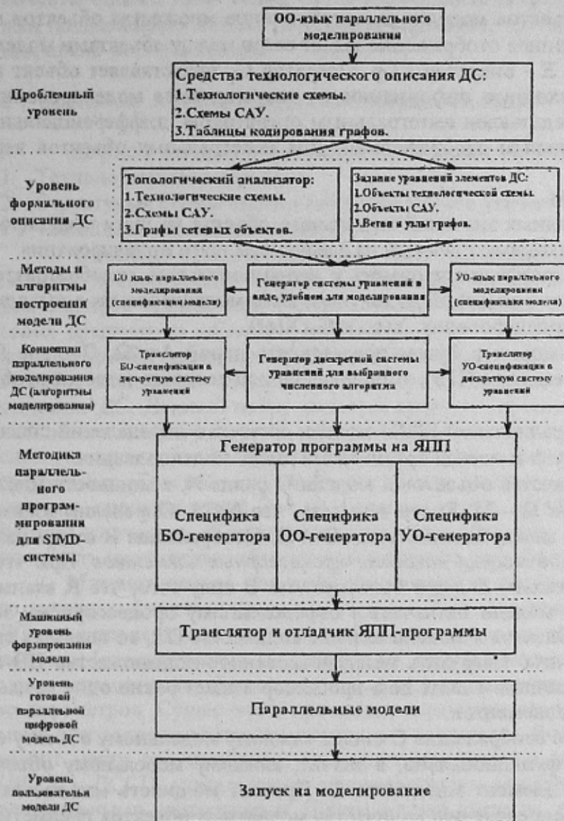
Рисунок 2 – Структура языка параллельного моделирования ДС, поддерживающего этапы построения параллельных моделей
