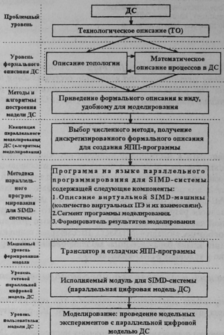
Рисунок 1 – Этапы построения параллельной модели динамической системы
