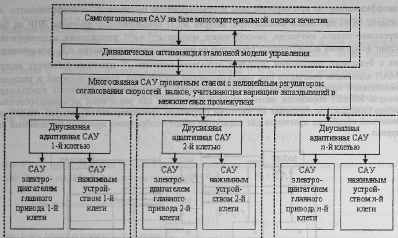
Рисунок 1 – Структура системы автоматического управления прокатным станом
