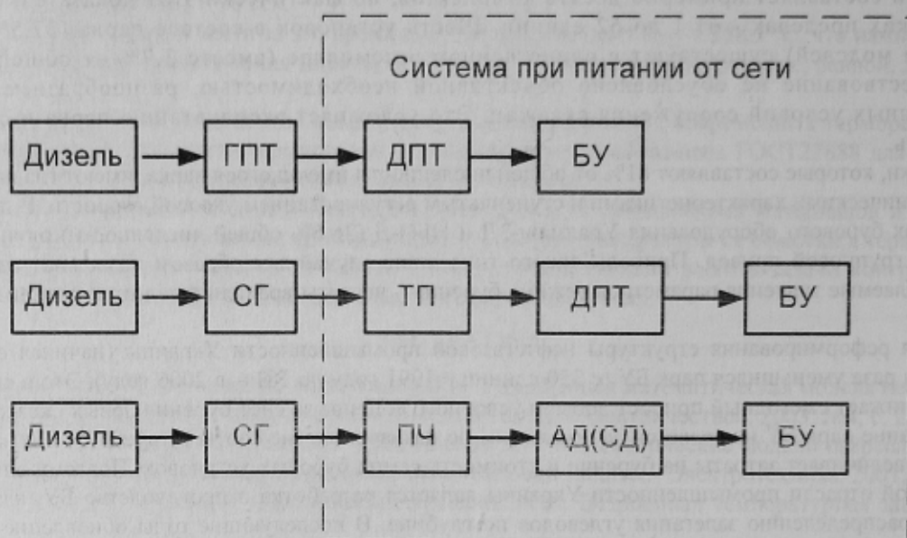
Рисунок 1 – Научно-техническая концепция построения систем плавного регулирования технологических параметров процесса бурения дизель-электрических БУ заграничного производства
