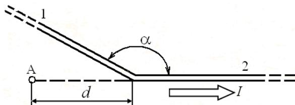
Рисунок 2.6 – Расположение точки А относительно изогнутого провода
