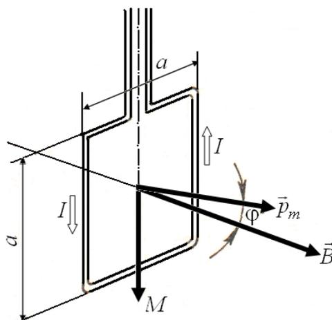
Рисунок 2.18 – Действие момента силы  $M$  на контур с током в магнитном поле
