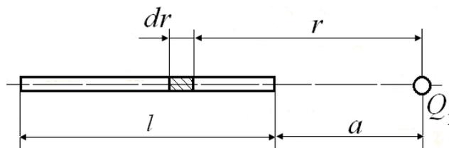
Рисунок 1.8 – Определение потенциала  $d\varphi$  в точке  $A$
