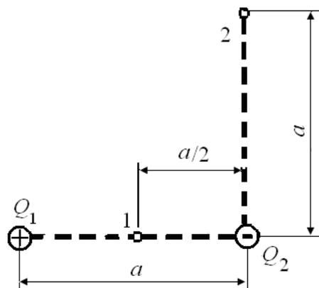
Рисунок 1.10 – Расположение точек 1 и 2 для примера 10
