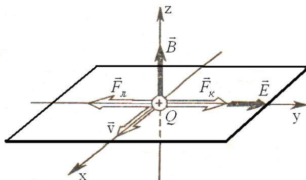
Рисунок 2.16 – Движение альфа-частицы в скрещенных полях
