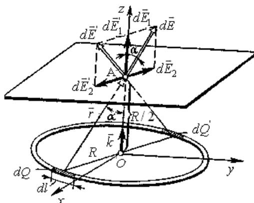
Рисунок 1.4 – Определение вектора  $\vec{E}$  в точке А
