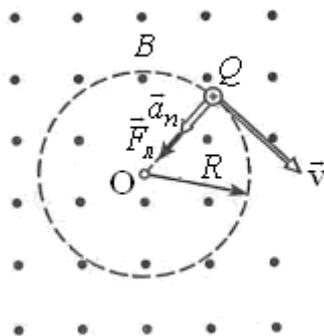
Рисунок 2.13 – Движение протона в магнитном поле с индукцией  $B$
