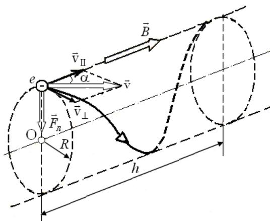
Рисунок 2.15 – Движение электрона по винтовой линии
