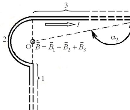
Рисунок 2.12 – Определение направления вектора магнитной индукции  $\vec{B}$  в точке O
