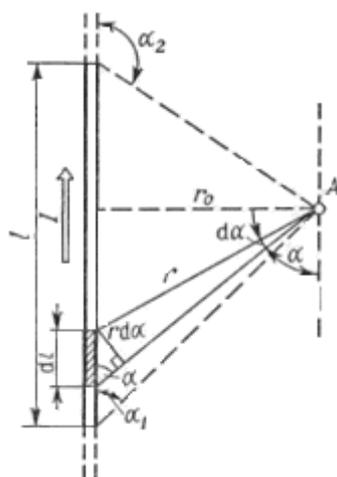
Рисунок 2.2 – Расположение точки А относительно отрезка прямого провода с постоянным током
