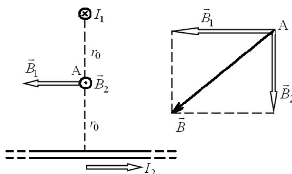
Рисунок 2.9 – Определение направления вектора магнитной индукции  $\vec{B}$  в точке А
