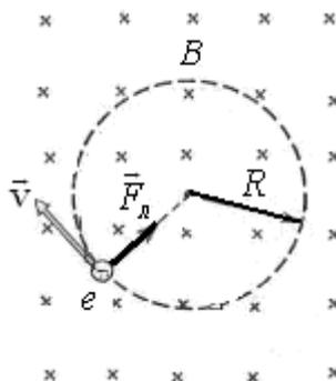
Рисунок 2.14 – Движение электрона в магнитном поле с индукцией  $B$
