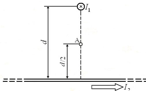
Рисунок 2.8 – Расположение точки А относительно проводов с токами  $I_1$  и  $I_2$
