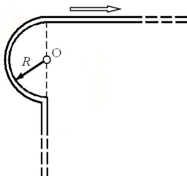
Рисунок 2.11 – Расположение точки  $O$  относительно провода с током
