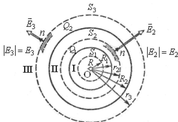
Рисунок 1.5 – Гауссовы поверхности для двух концентрических сфер
