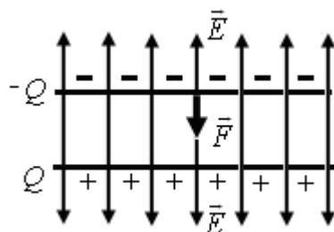
Рисунок 1.9 – Определение силы  $F$ , с которой притягивают пластинки
