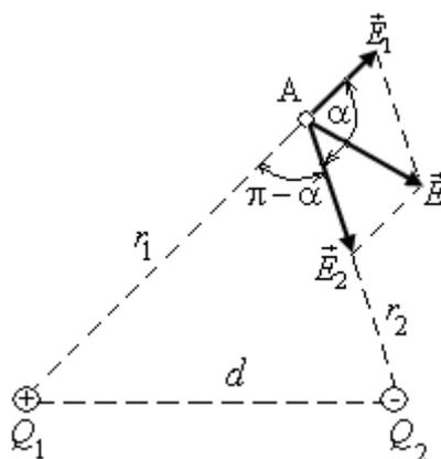
Рисунок 1.3 – Определение вектора  $\vec{E}$  в точке А
