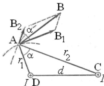
Рисунок 2.4 – Определение вектора индукции  $\vec{B}$ , создаваемого двумя параллельными бесконечно длинными проводами D и C
