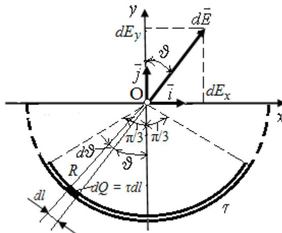
Рисунок 1.7 – Напряженность  $d\vec{E}$  поля, создаваемого зарядом  $dQ$
