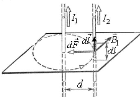
Рисунок 2.10 – Определение направления действия силы Ампера  $d\vec{F}$ , действующей на элемент  $d\vec{l}$  провода
