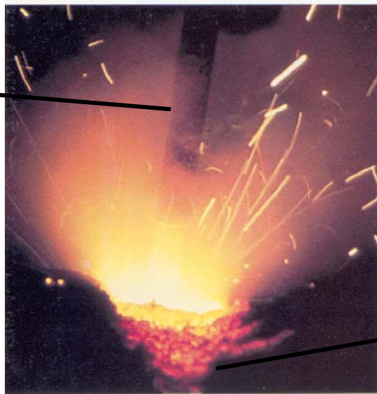
Рис. 3. Получение материала методом керамической наплавки. 1 – торкрет-фурма; 2 – материал керамической наплавки
