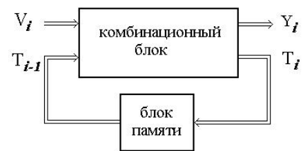
Рис.1. Модель синхронной последовательностной схемы.
