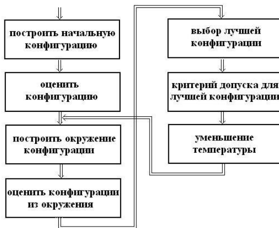
Рис.2. Общая схема алгоритма симуляции отжига.
