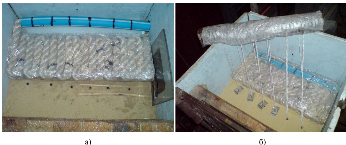
Рис. 3. Общий вид ящика внутри модели при расположении в нем капронового каната с извлекаемой направляющей пластиковой трубой (а) и комплекта арочной металлической крепи с нитями-тягами контурных реперов (б)
