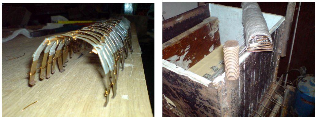
Рис. 5 Общий вид арочной крепи с двумя продольными балками (а) и комплект крепи с поперечными лежнями перед установкой в модели (б)
