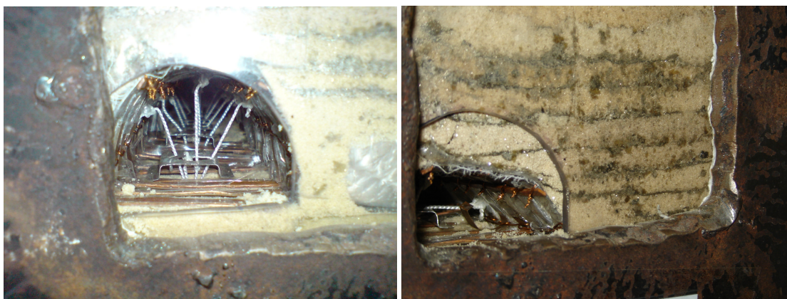
Рис. 6 Характер деформирования боковых пород и арочной крепи выработки при расположении лавы в средней части модели (а) и после ее полной отработки (б)
