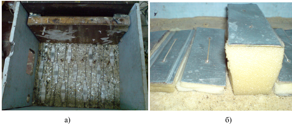
Рис. 4 Расположение датчиков давления в почве пласта по основанию стенда вид сверху (а) и боковой вид сжатых полосок поролон за счет натяжения жестяной пластины капроновой нитью (б)
