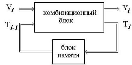
Рис.1. Модель синхронной последовательностной схемы.
