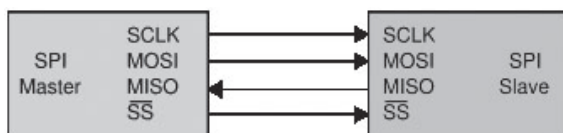
Рисунок 1 – Простейшее подключение к шине SPI
