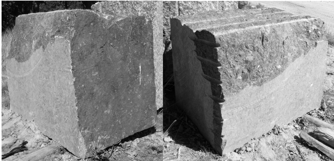
Рис. 1. Цифрові знімки товарного блоку з коефіцієнтом заповнення 74% (а) і 68% (б) та кутом фотографування 45^{\circ} (а) і 135^{\circ} (б)
