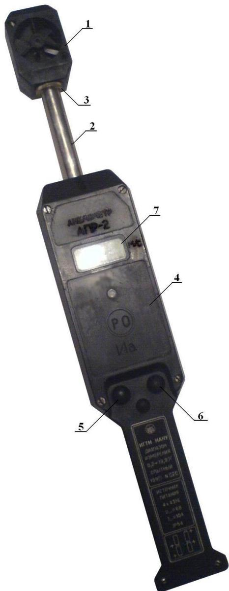
Рис. 10.1 – Анемометр АПР-2
