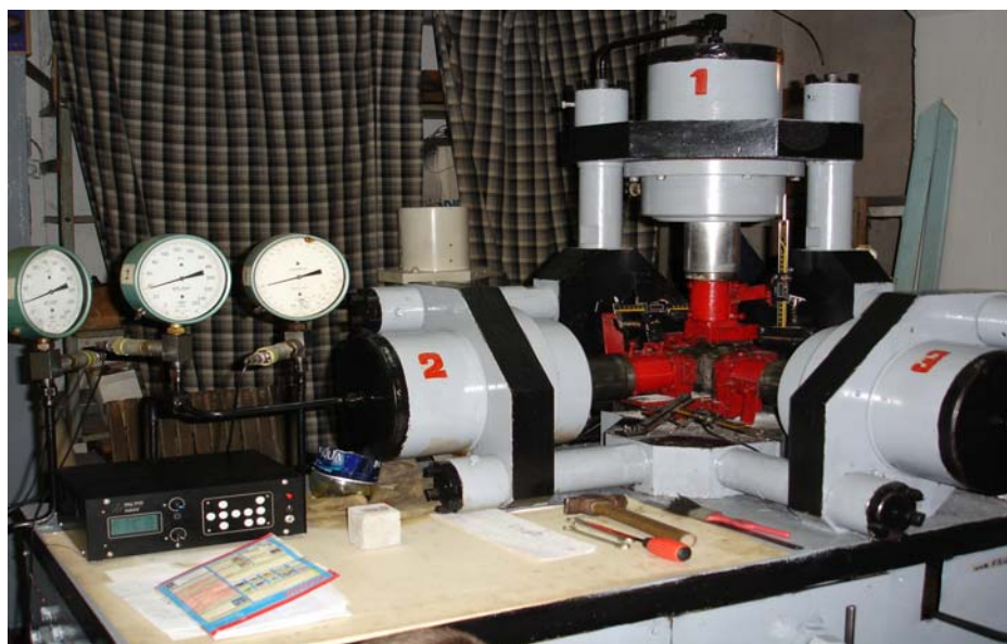
Рис. 2. Общий вид установки для испытаний образцов на объемное сжатие
