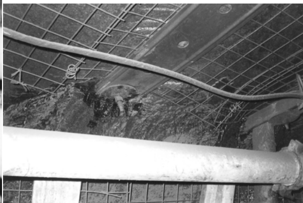
Рис. 9 – Выдавливание верхней угольной пачки в месте крепления подхвата у стенки выработки
