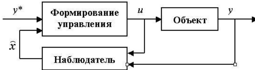
Рисунок 2 – Функциональная схема САУ с наблюдателем полного порядка
