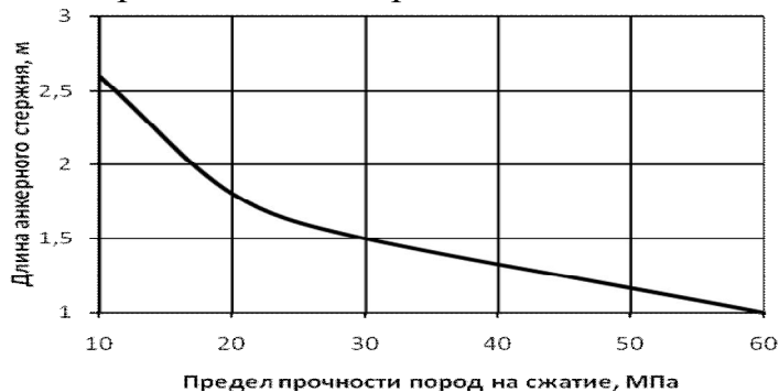
Рисунок 9- Залежність довжини анкера від міцності порід в зоні впливу очисних робіт
