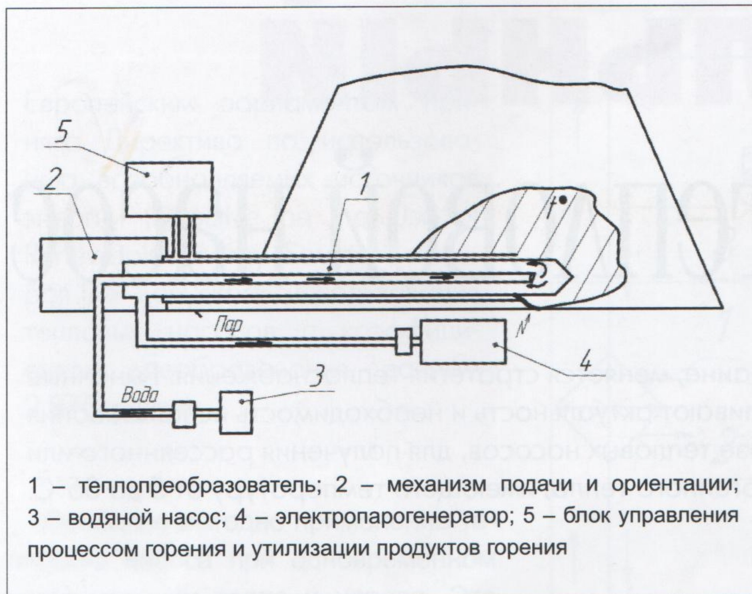
Рис. 1. Схема использования энергии горящих терриконов
