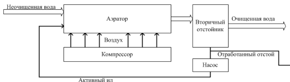
Рис. 1. Общий вид процесса биологической очистки
