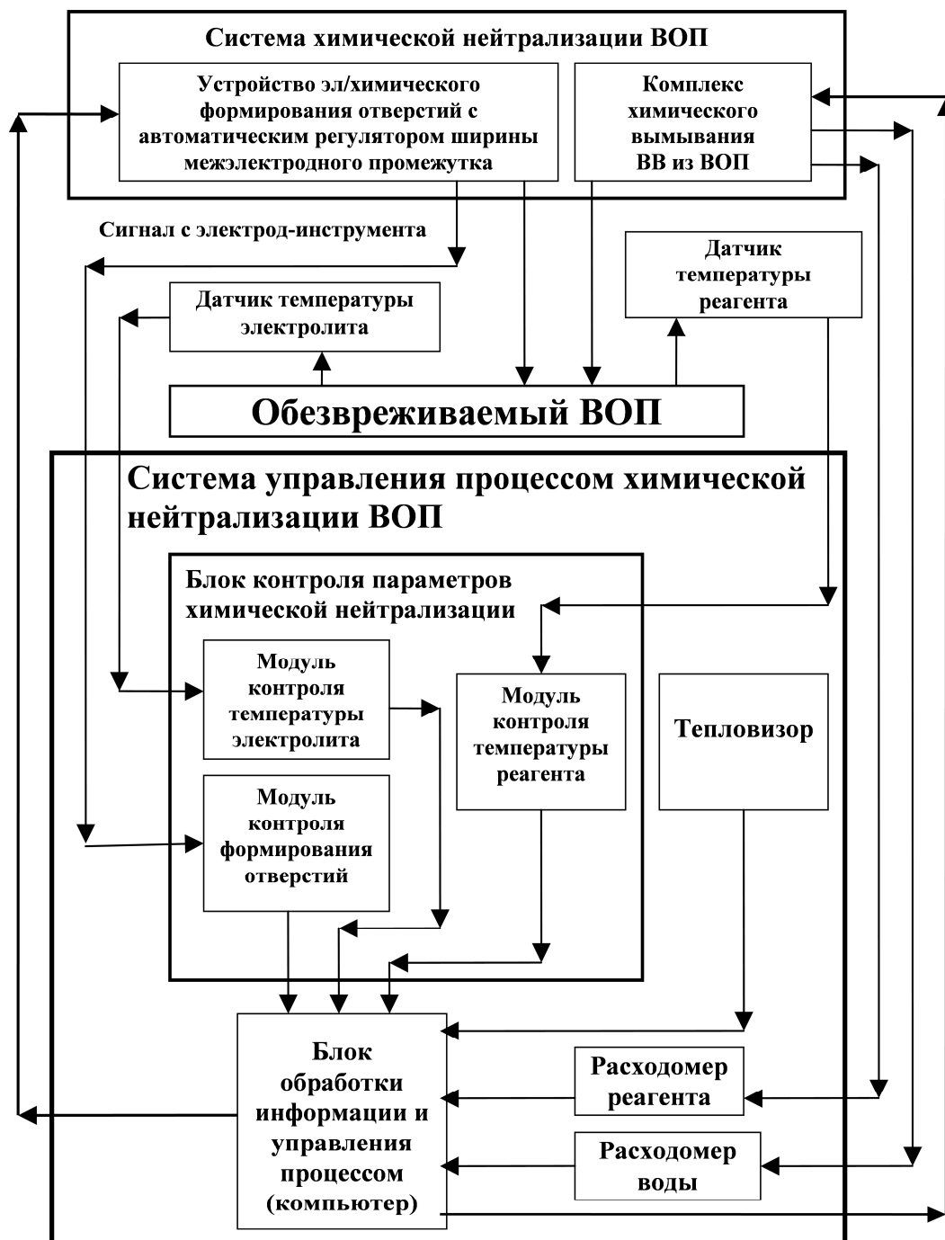
Рисунок 1 - Структурная схема системы управления процессом химической нейтрализации в комплексе с системой химической нейтрализации ВОП
