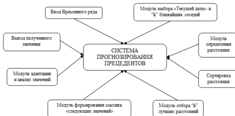
Рисунок 1 – Диаграмма модулей разрабатываемой системы
