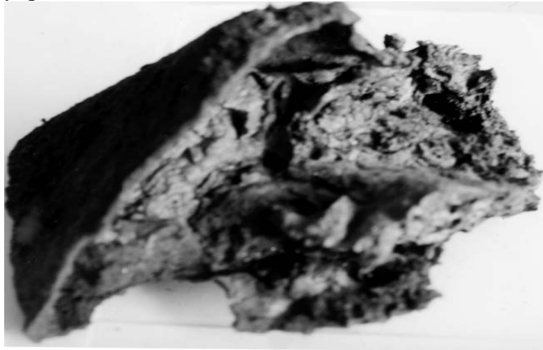
Рисунок 1 – Частично расплавленная чушка чугуна, извлечённая из плавильной зоны вагранки
