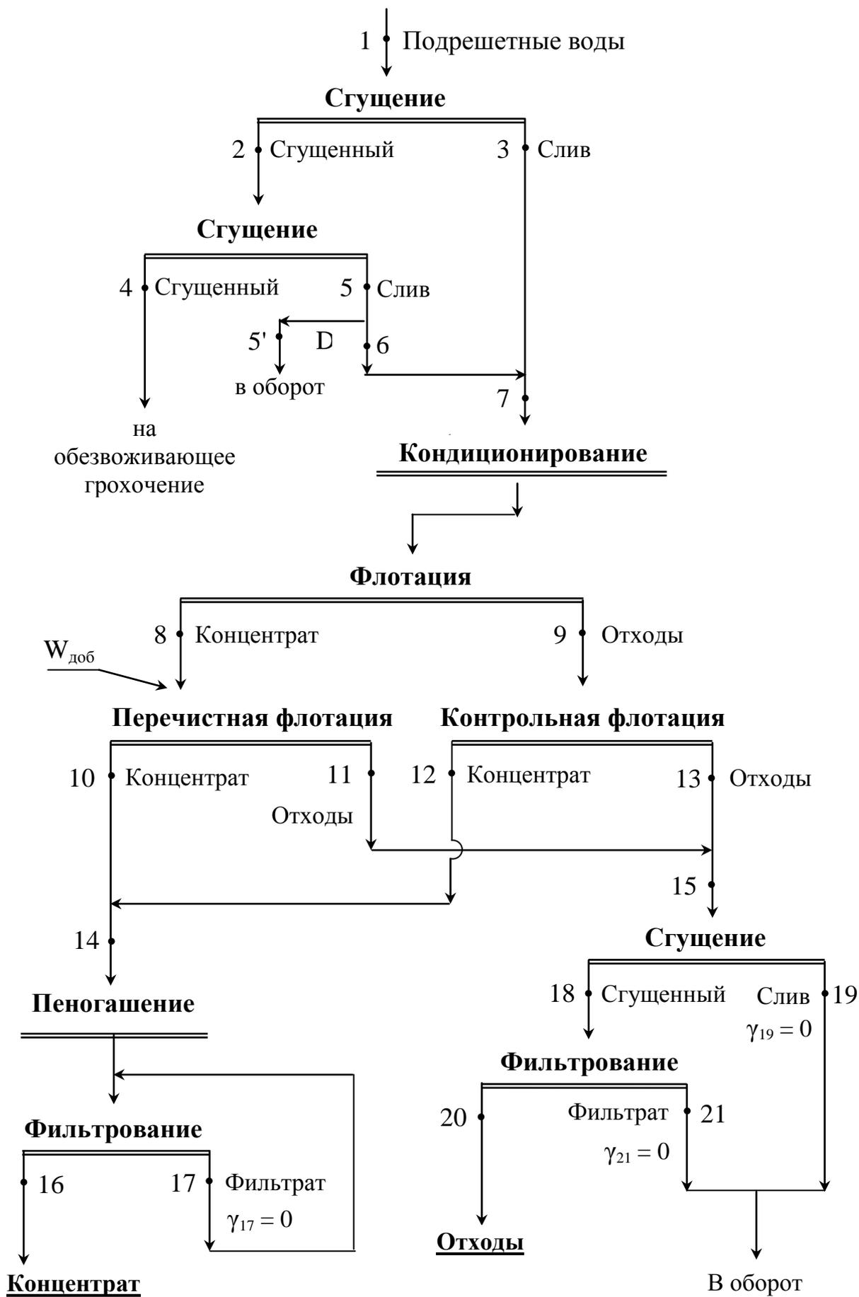
Рис. 2.1 – Технологическая схема флотационного отделения
