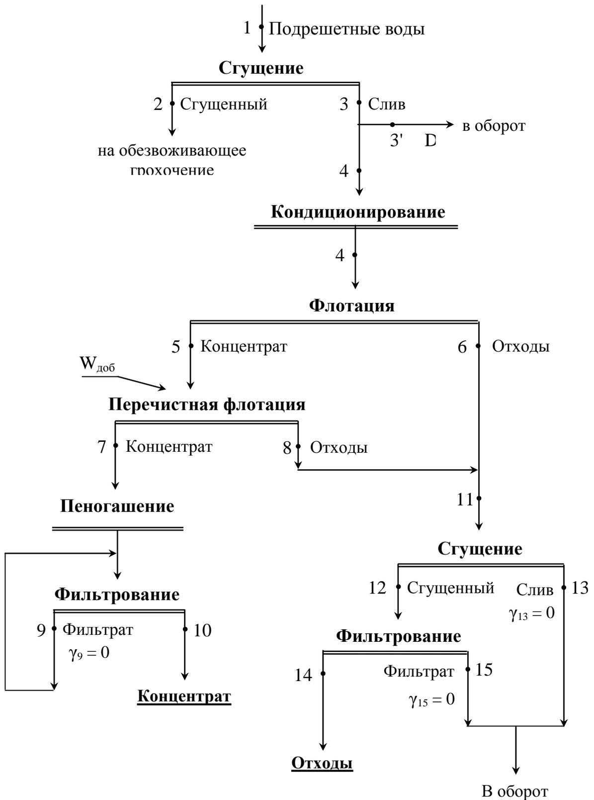
Рис. 1.2 – Схема с использованием перечистой флотации для получения кондиционного концентрата (схема 2)
