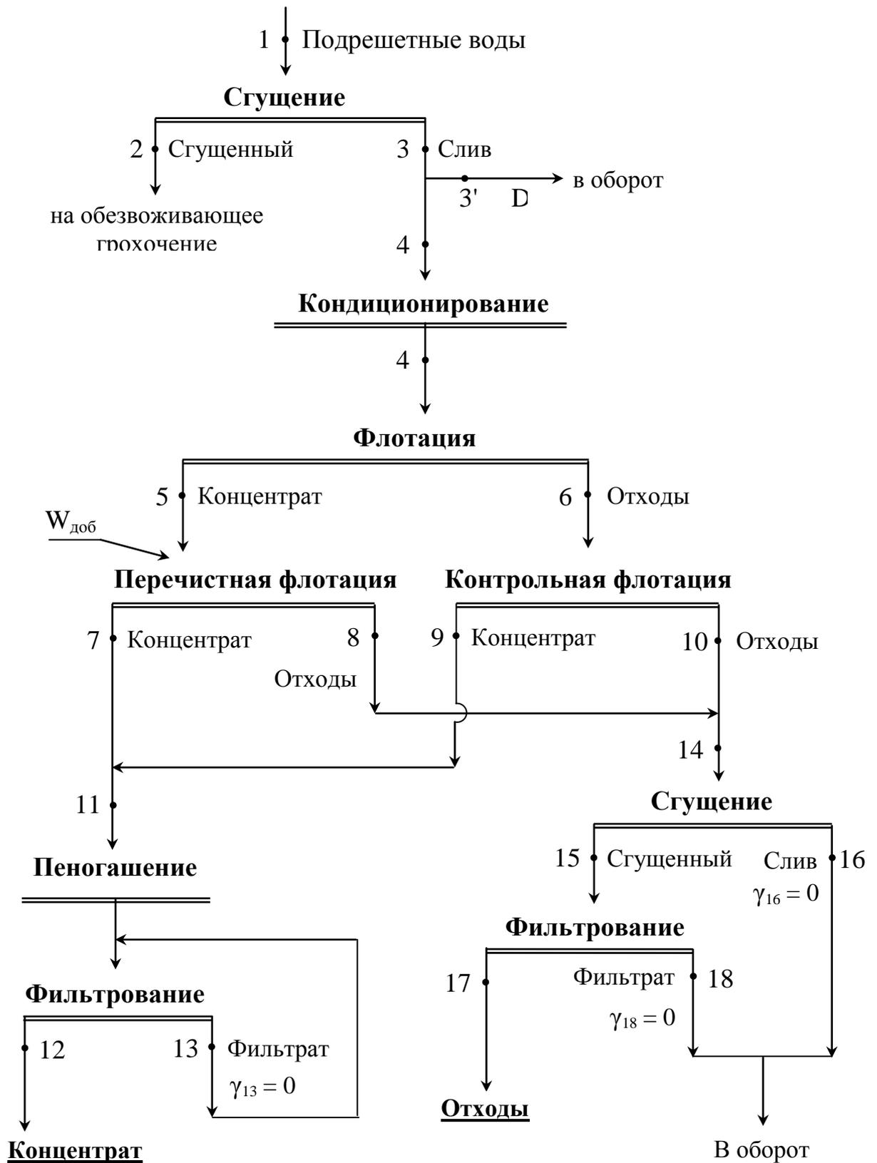
Рис. 1.4 – Схема с использованием перечистой и контрольной флотации для получения кондиционных продуктов (схема 4)
