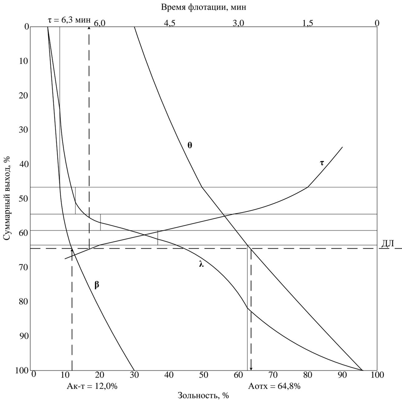
Рис. 2.2 – Кривые флотируемости угольного шлама
