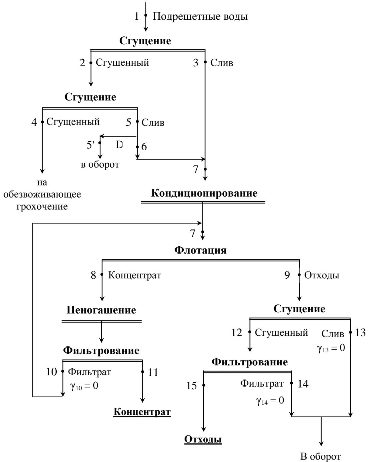
Рис. 1.1 – Схема обработки подрешетных вод с использованием двух стадий сгущения (схема 1)
