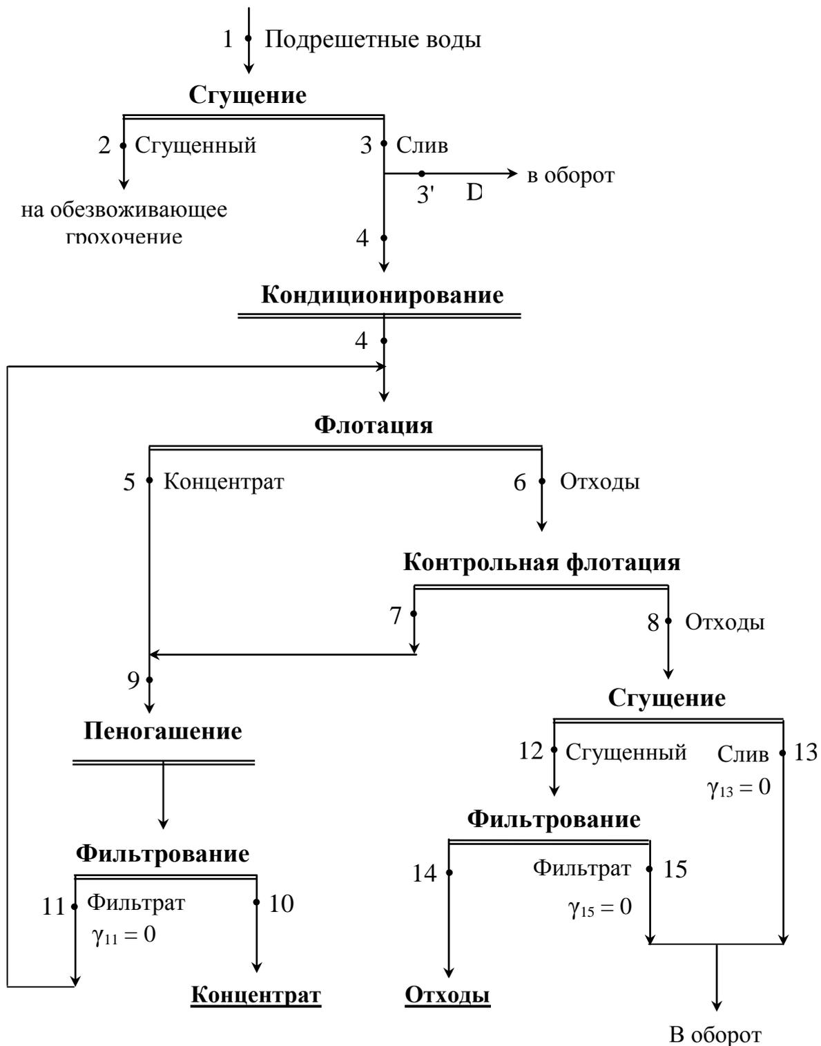
Рис. 1.3 - Схема с использованием контрольной флотации для получения высокозольных отходов (схема 3)
